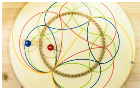
Figura 36. Tauler amb un engranatge circular fix i un conjunt de peces circulars dentades. Si es fan rodar per l'interior, obtenim diverses hipocicloides. Si es fan rodar per l'exterior, obtenim les epicicloides
