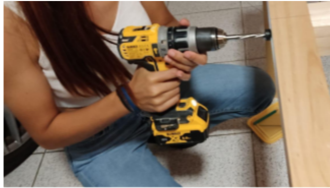
Figura 35: construcció de potes de la Sandbox . Aquí s'està fent un forat perquè el vis hi càpiga bé. Font pròpia.
