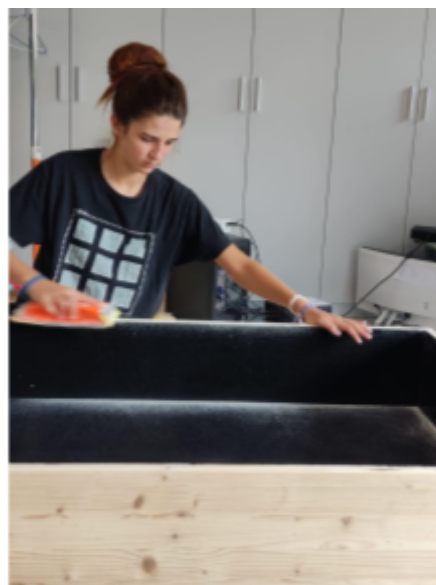
Figura 39: construcció de la Sandbox . Fase de polir i arrodonir els costats i puntes. Font pròpia.
