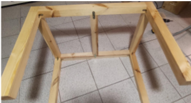
Figura 36: construcció de les potes de la Sandbox . Es pot veure com, a part dels visos, també estan enganxades amb angles de metall. Font pròpia.
